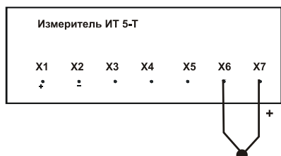
Рисунок В.3 – Схема подключения преобразователя термоэлектрического с НСХ ХК(L).
