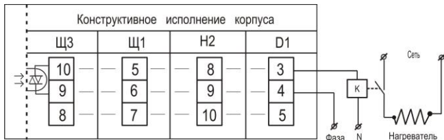
Схема подключения терморегулятора PATAP-02M.TC с симисторным выходом
