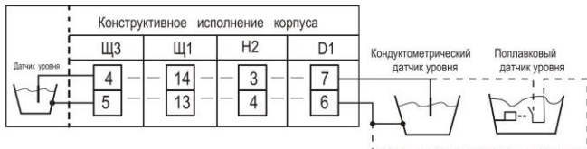
Схема подключения датчика уровня к терморегулятору ПАТАР-02М.ТС
