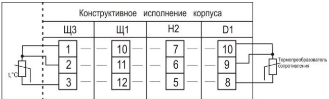
Схема подключения датчика температуры к терморегулятору PATAP-02M.TC
