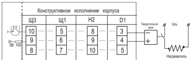
Схема подключения терморегулятора ПАТАР-02М.ТС с транзисторным выходом
