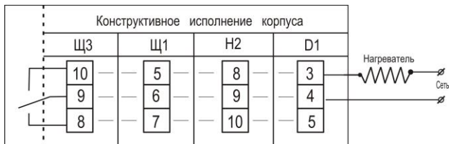
Схема подключения терморегулятора ПАТАР-02М.ТС с релейным выходом
