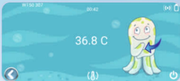
Спустя небольшое время на экране отобразится текущая температура и время с начала измерения.
